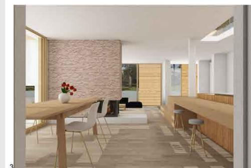
La ventilazione naturale della casa è facilitata dalle vetrate scorrevoli poste sui lati ovest e sud della casa, con espulsione dell'aria calda da un'ulteriore apertura posta in copertura in direzione della zona di cottura.
